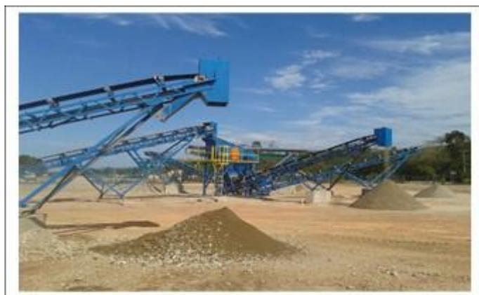
**Figura 5** – Usina de Reciclagem de (RCD), Capacidade de Produção 70/80 toneladas/hora
