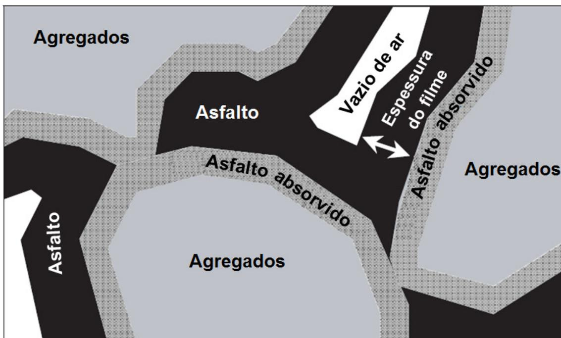
**Figura 12.** Representação de uma mistura asfáltica típica.
