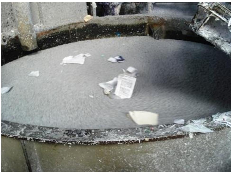
**Figura 2** – Mistura pasta celulósica em água (Hidrapulper)
