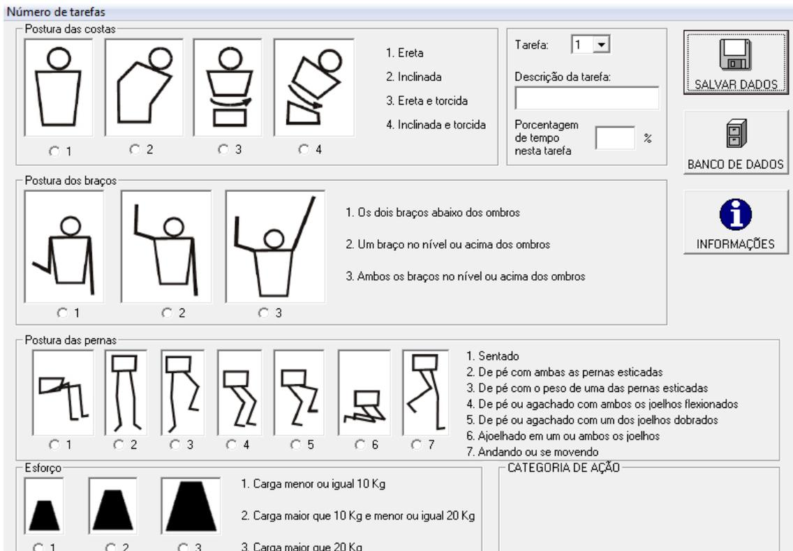
**Figura 10 – Método OWAS (Classificação da Postura – Esforço)**
