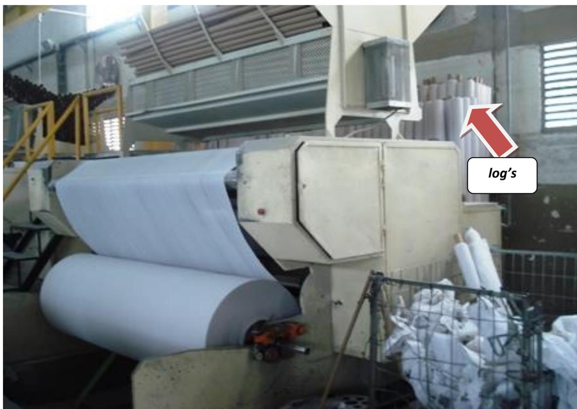
**Figura 29** – Rebobinadeira (Vista lateral)
