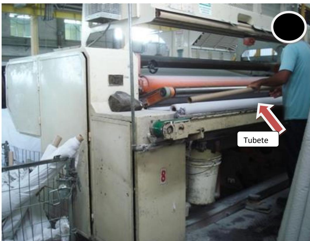
**Figura 28** – Rebobinadeira (Vista frontal)
