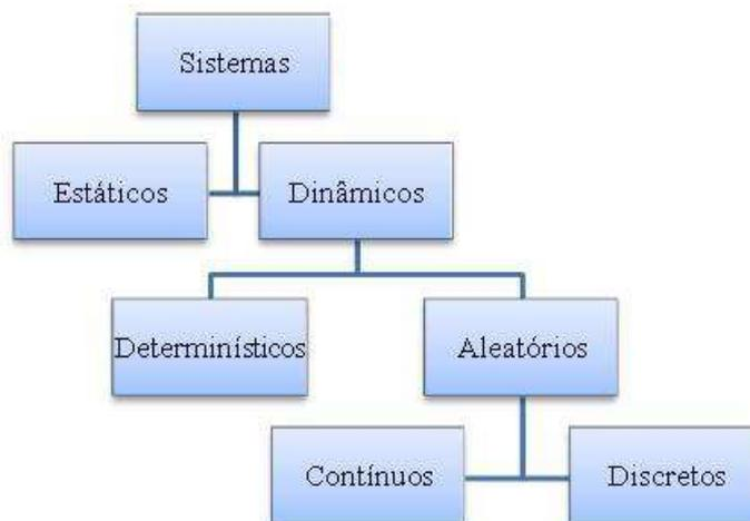
**Figura 5:** Classificação dos sistemas para modelagem e simulação
